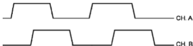
Рис. 4.19: Сигналы на выходе CH A и CH B квадратурного энкодера
