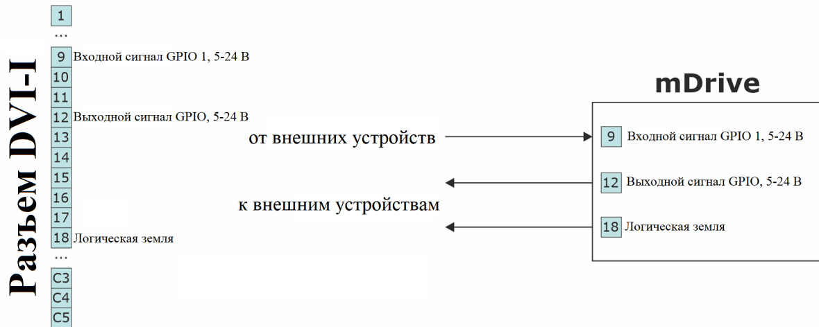
Рис. 4.48: Схема подключения к цифровому входу и выходу на плате контроллера
