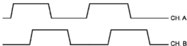
Рис. 4.23: Сигналы на выходе CH A и CH B квадратурного энкодера
