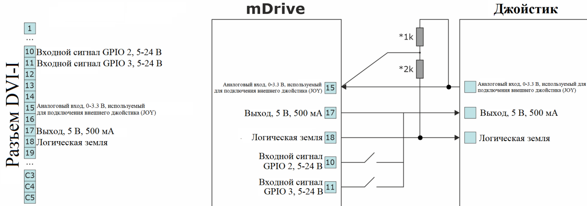
Рис. 4.34: Подключение джойстика (до 5 В) к mDrive через разъем DVI-I (сопротивление «*» рассчитывается индивидуально в зависимости от используемого джойстика)
