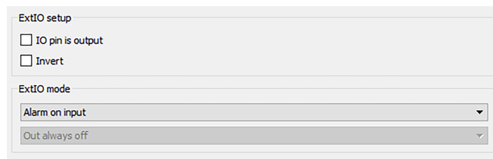
Рис. 8.15: Настройка цифрового входа EXTIO для работы в режиме «Alarm on input» (аварийная остановка)
