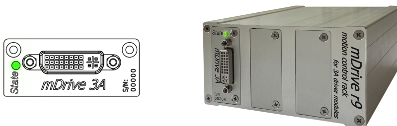
Рис. 4.29: Передняя панель контроллера mDrive с двухцветным светодиодом
